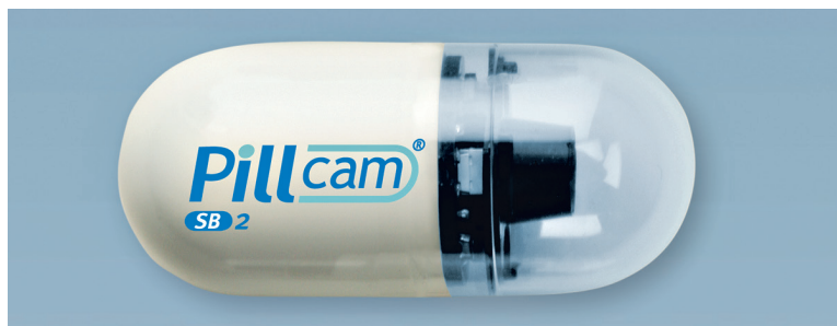
Obr. 5 Snímač obrazu střevní stěny (podrobnosti k vlastnostem a využití lze nalézt v materiálech výrobce givenimaging.com)
