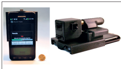
Obr. 4 Přístroj k detekci albuminu v moči UCLA (Kalifornská univerzita v Los Angeles)( http://www.engineer.ucla.edu/newsroom/featured-news/archive/2013/ozcan-albumin-tester )
