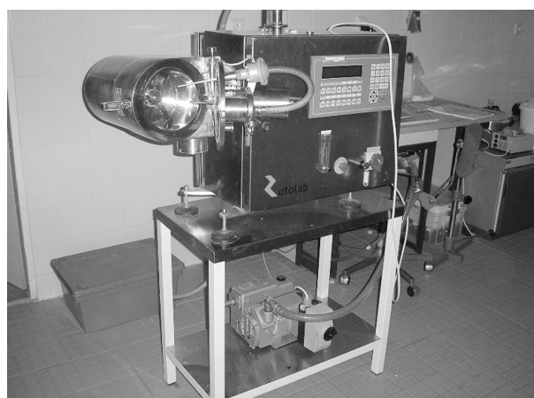
Obr. 2. Jednostupňový granulátor s vakuovým sušením Rotolab ZANCHETTA
