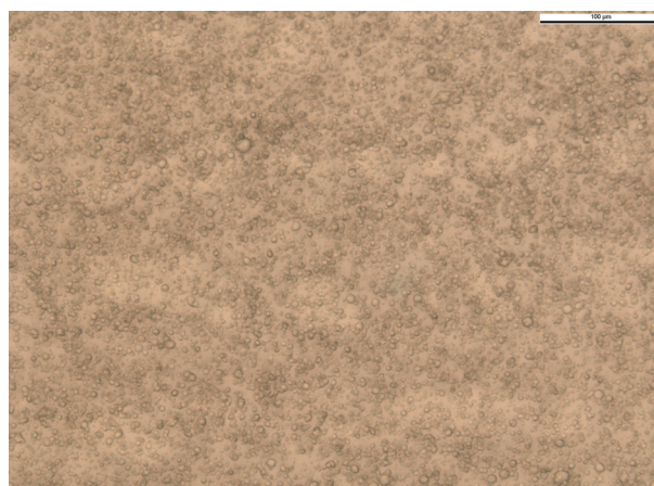
Obr. 4. Lidokainový emulgel s 5 % lidokainu, 0,6 % thymolu, s 3 % trometamolu (90. den od přípravy, zvětšení 400x)
