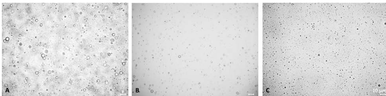
Obr. 3. Mikroskopický vzhled gelů obsahujících 0,3 % polysorbátu 80: A – bez xylitolu, B – 10 % xylitolu, C – 20 % xylitolu
