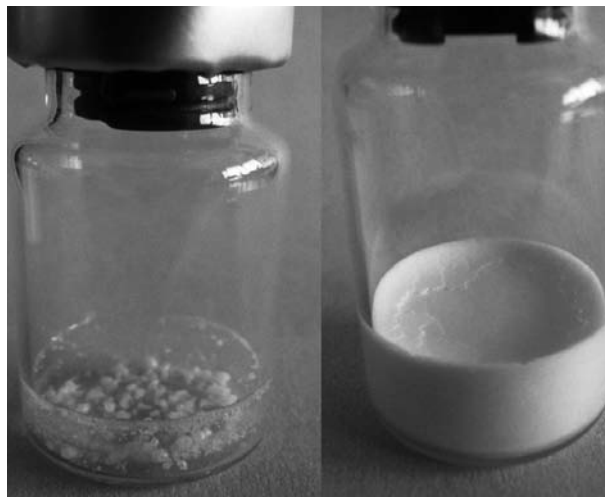
Obr. 1. Zrútený (vľavo) a vzhľadovo vyhovujúci lyofilizát (vpravo)
