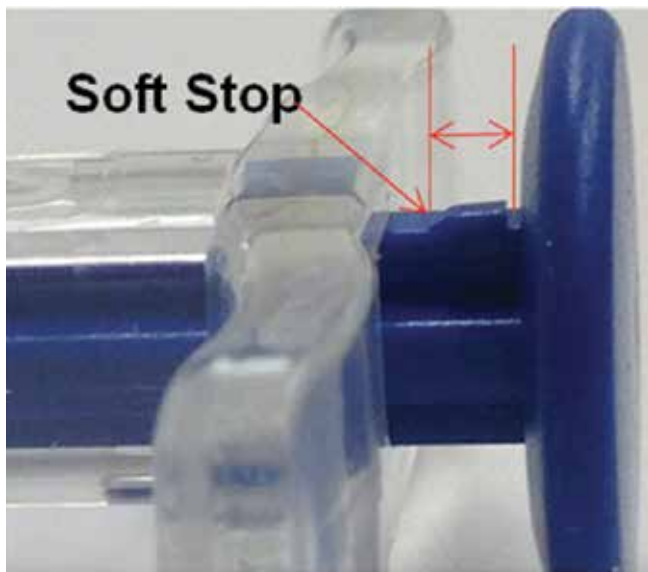
Obrázek 3. Soft stop koncovka injektoru CT LUCIA 611P(Y)
