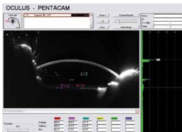
Obrázek 1. Scheimpflugova fotografie. Měření relativní opacity (v %) ve dvou polích v materiálu NOČ v řezu ( 90^\circ až 270^\circ ) při první kontrole. Za isolinii byla stanovena opacita v opticky prázdné přední komoře nad přední plochou NOČ
