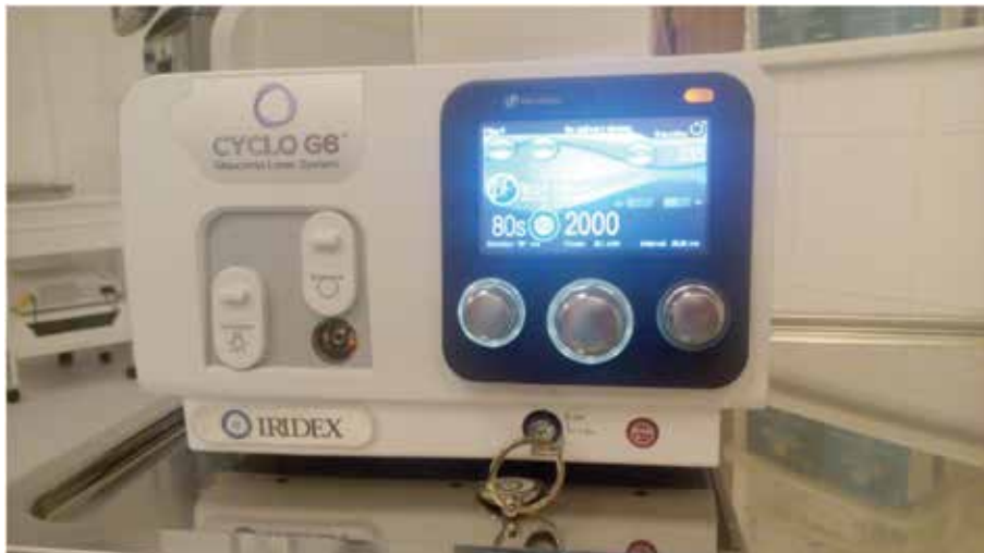
Obrázek 1. Laser Cyclo G6 firmy Iridex. Na monitoru přístroje je vidět nastavení parametrů: délka aplikace 80 sekund, energie 2000 mW
