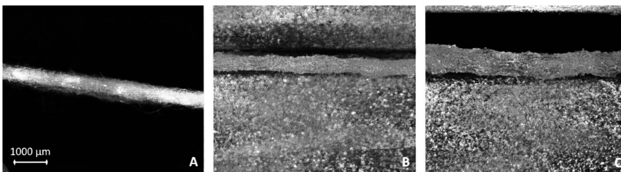
Obr. 6. Mikroskopický vzhled tloušťky kyselé formy CMC v podobě textilního krytí s DS 0,35 (zvětšení 7,5krát): (A) v suchém stavu, (B) po 15 min. v tlumivém roztoku fyziologickém o pH 7,2, (C) po 3 dnech v tlumivém roztoku fyziologickém o pH 7,2
