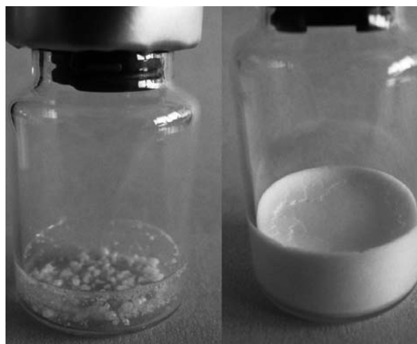
Obr. 1. Zrútený (vľavo) a vzhľadovo vyhovujúci lyofilizát (vpravo)
